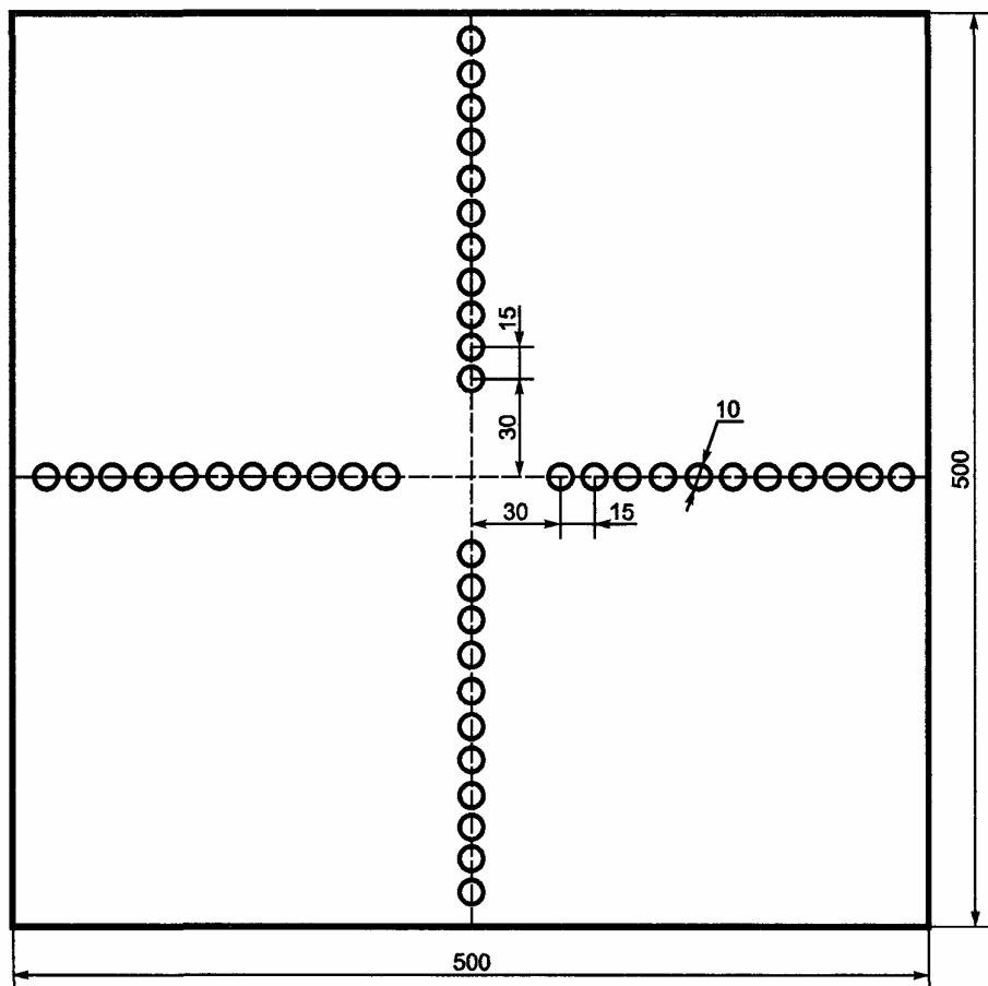
$d$  — диаметр отверстия (10 мм). Толщина тест-объекта 1 мм.
