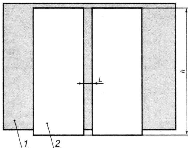
1 — протяженный излучатель; 2 — тепловой тест-объект толщиной 1 мм
